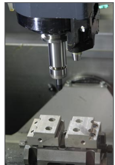
Mechanischer Zentrierspanner in Aktion
